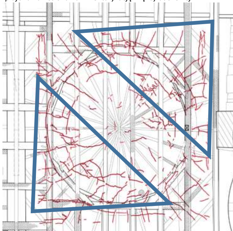
Fot. 87. Mapa spękań plafonu naniesiona na inwentaryzację więźby dachowej. Zagęszczenie zarejestrowanych pęknięć w obszarach przylegających do narożników SW i i NE.
